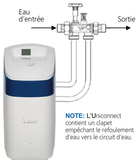
**NOTE:** L'Uniconnect contient un clapet empêchant le refoulement d'eau vers le circuit d'eau.
