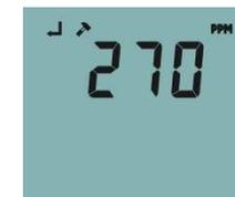
Appuyez une fois sur la touche [CONFIRMER] pour entrer la dureté et mettre l'affichage en mode Réglage du temps de charge.
